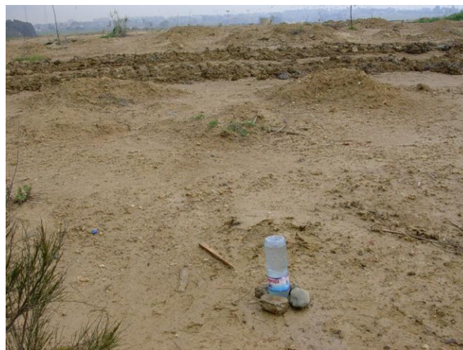
Figure 24 : Méthode en fouille pour l'évaluation de la perméabilité CET d'Ouled Fayet (casier 1 fermé).
