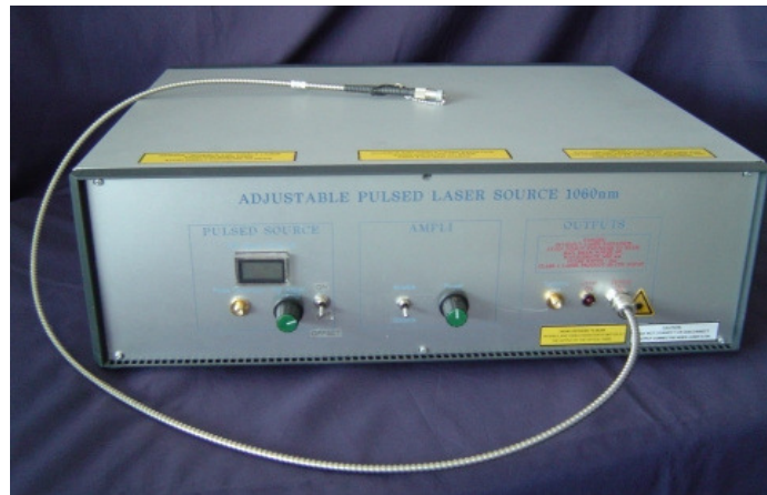
Figure V-15 : Photo du supercontinuum Multitel. Source réalisée par XLIM et Leukos.
