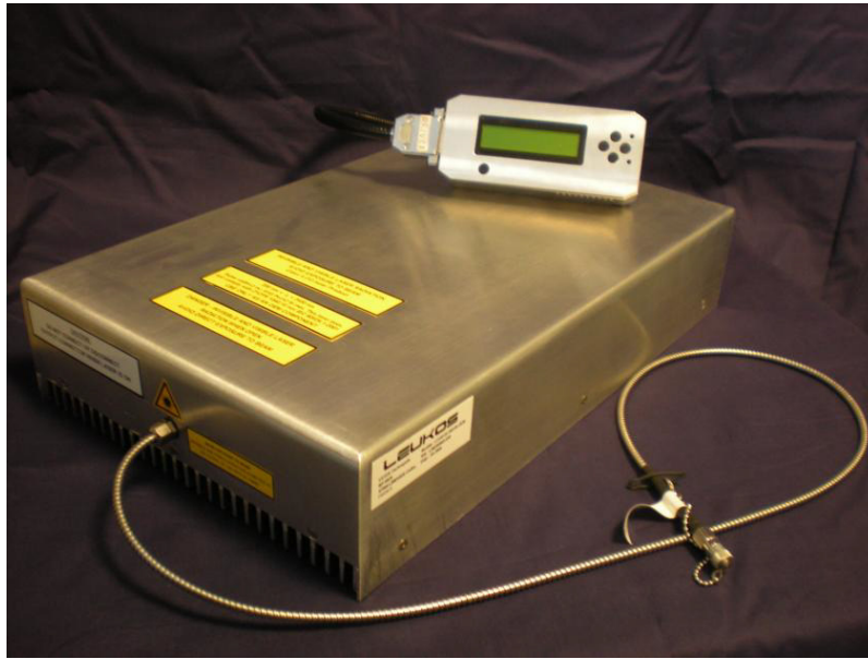
Figure V-18 : Photo de la source supercontinuum Altechna. Supercontinuum réalisé par XLIM et Leukos.
