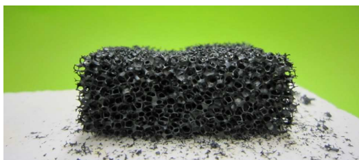
Figure 15 Mousse pérovskite après frittage à 1350°C
