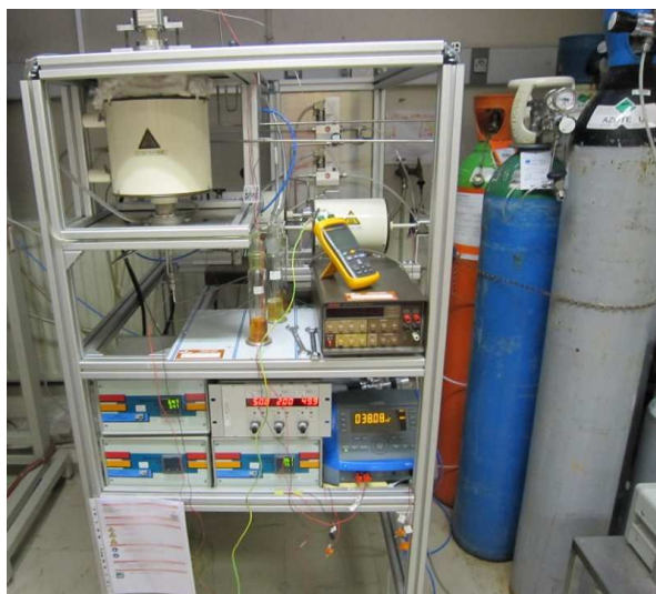
Figure 11 Nouveau montage expérimental de semi-perméation à l'oxygène permettant la mesure de l'activité de l'oxygène aux surfaces de la membrane
