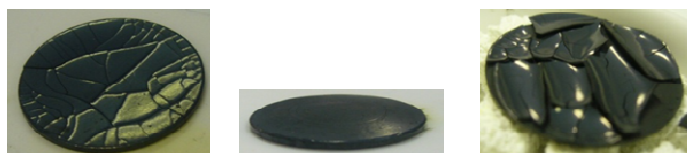
Figure 3 Différents défauts de la membrane après frittage
