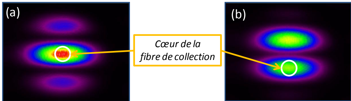
Figure II-31 : Champs lointains obtenus lorsque la fibre de collection est centrée (a) ou excentrée (b).
