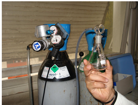
Figure 7 : L'atomiseur relié à la bouteille du gaz vecteur.
