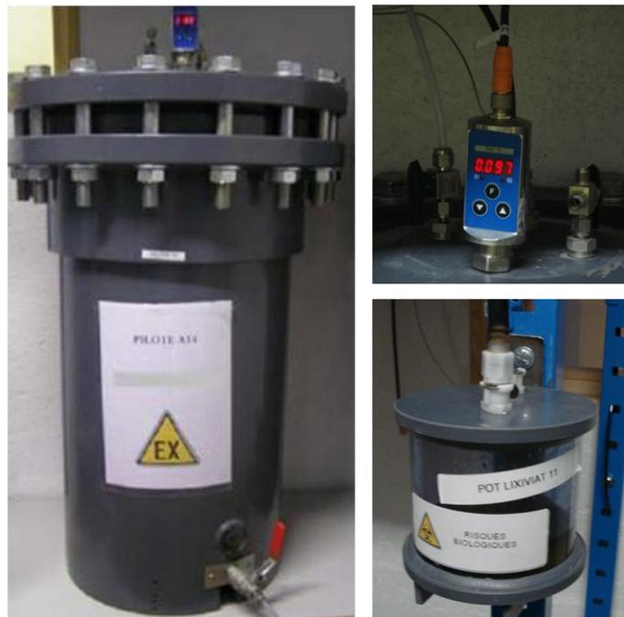
Figure 25 : Pilotes 68 L du programme BIOPTIME.
