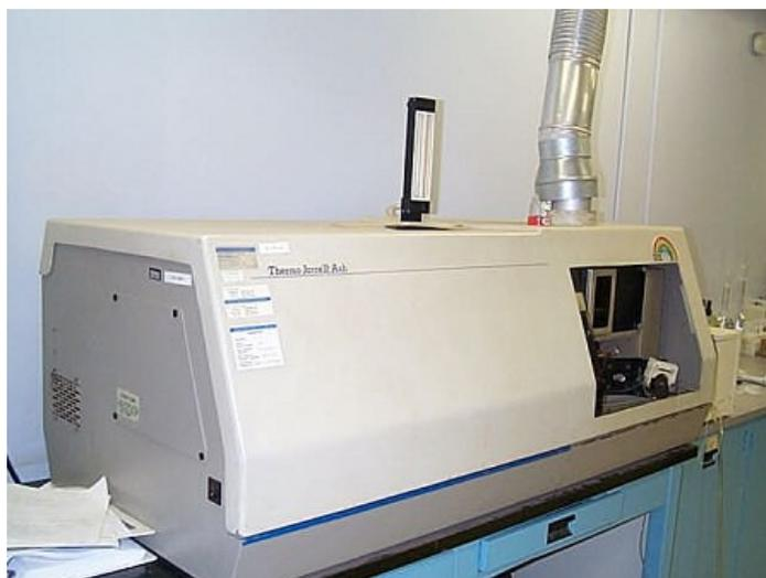
Fig.10.1. Spectromètre d'émission par plasma induit IRIS de Thermo Jarrell
