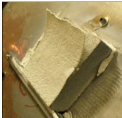
Figure 65 : Démouillage du dépôt pour deux passes de projection.
