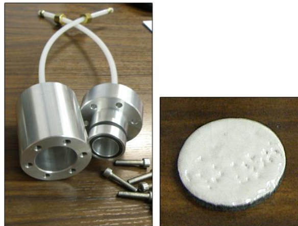
Figure 44 : Cellule de mesure de perméabilité et échantillon SNBSC émaillé.
