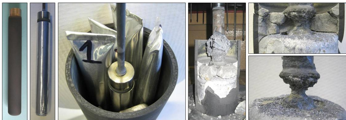
Figure 81 : Barreau revêtu d'un dépôt TiO_2 , enveloppé d'un film d' Al , avant et après un test de corrosion.
