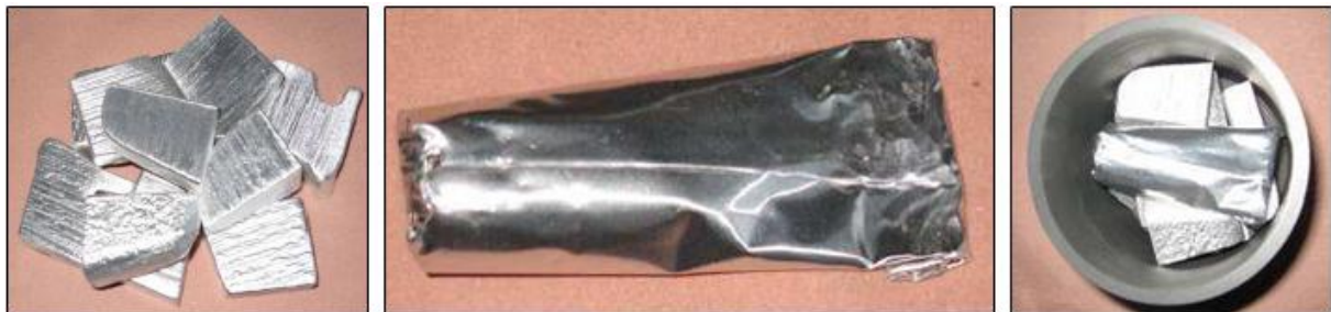
Figure 52 : Aluminium en lingot, bain en berlingot et creuset en graphite.
