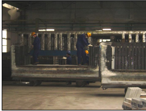
Figure A.2.2 : Chariots pour transporter les briques de SNBSC au four.
