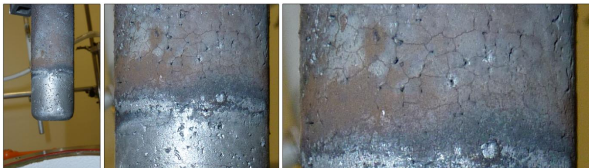
Figure 82 : Corrosion d'un dépôt TiB_2 dans un bain cryolithique.
