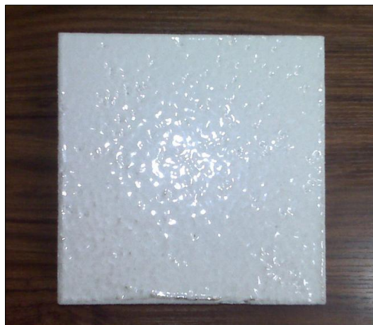
Figure 70 : Emaillage optimisé d'un substrat SNSBC, avec une sous-couche de laiton projeté par arc fil, réalisé par projection flamme-poudre.
