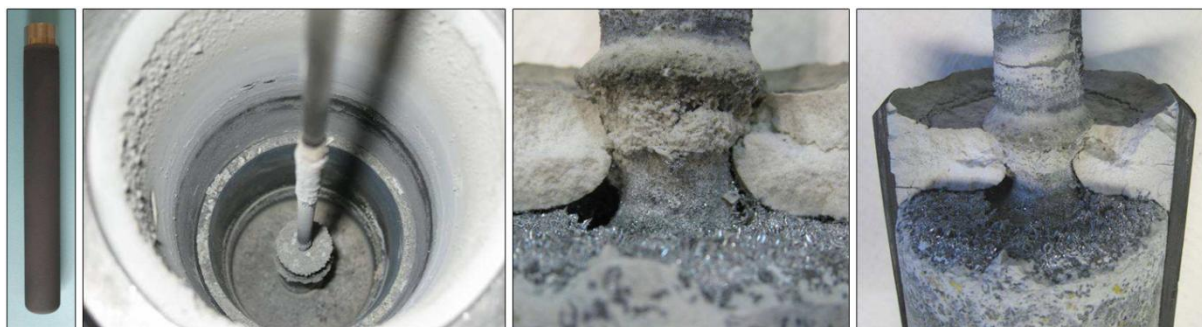
Figure 80 : Corrosion des dépôts TiO_2 par un bain électrolytique.
