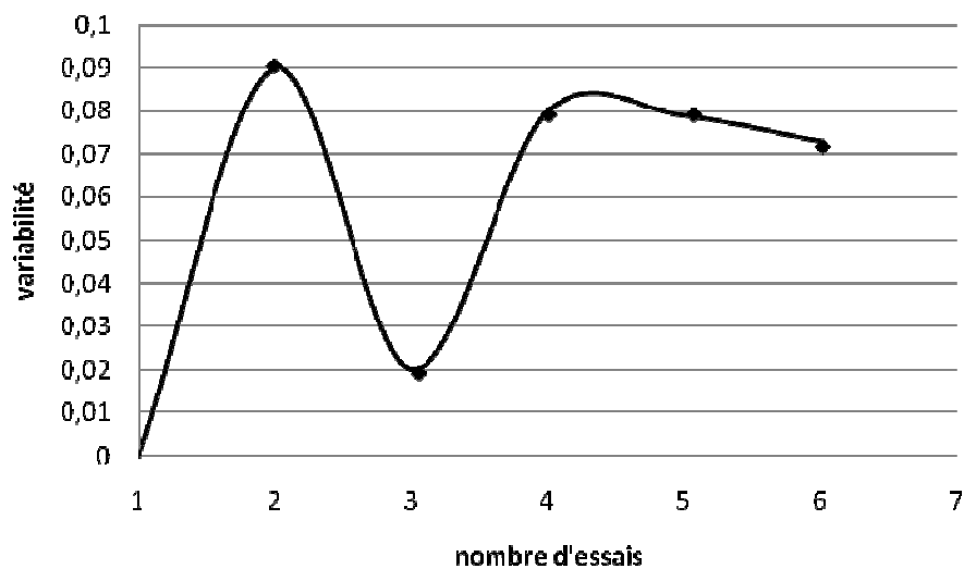
Figure IV-15 : Analyse de la variabilité de la mesure de porosité du dépôt réalisé avec le jeu de paramètres 1 par analyse d'image (cf paramètres opératoires Tableau IV-1)
