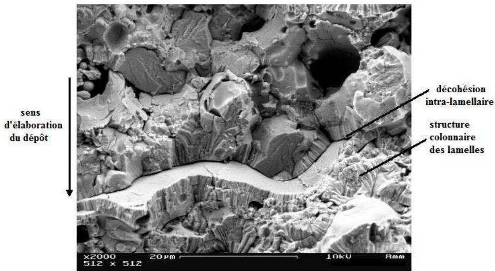
Figure 1-7. Aspect lamellaire et fissuré d'un dépôt de zircone yttrée projeté par plasma (cliché ONERA).
