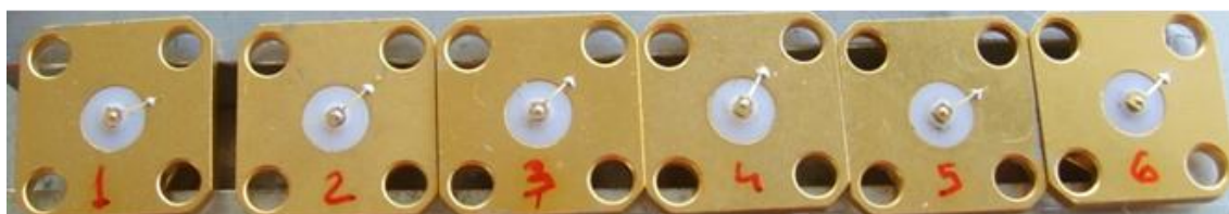
Figure II- 20 : Photographie des capacités MIM montées sur des connecteurs SMA pour être mesurées.
