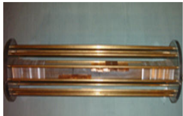
Figure A1.44 – Prototype de l'antenne B.I.E omnidirectionnelle
