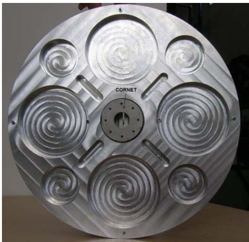
Photographie IV.3 : Antenne réalisée (vue arrière)
