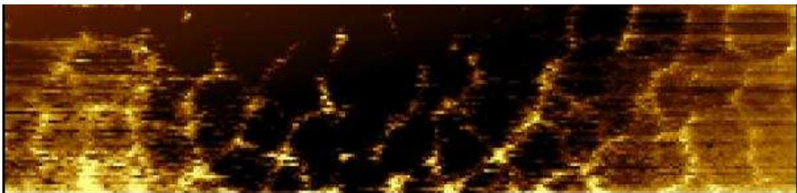
**Figure 98 : Image TUNA (taille : 1  $\mu\text{m}$ ) obtenue dans le cas d'une couche mince de NBT, d'épaisseur 230 nm, déposée sur Pt(100)/MgO(100). La tension appliquée est de -8 V.**
