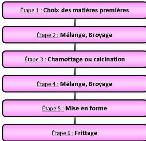
Figure 33 : Diverses étapes de la réalisation des cibles par voie solide.
