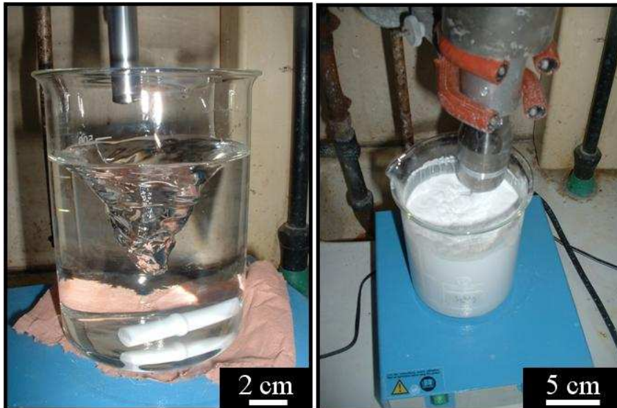
Figure 52 : Préparation des suspensions sous agitation magnétique et ultrasons
