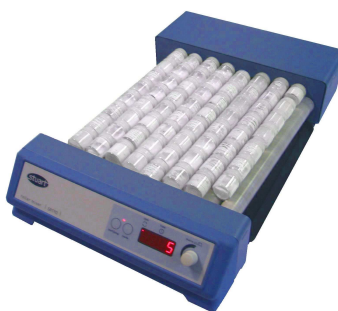
Figure 3.12 : Agitateur basculant de type Rock'n Roll (Stuart Roller Mixer SRT9D) utilisé pour la granulation aqueuse
