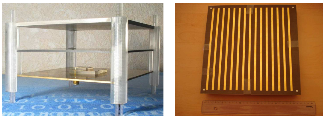
(a) Antenne BIE bibande diélectrique
