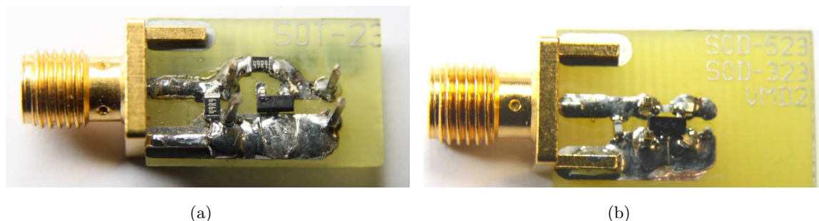
FIGURE 4.14 – (a) Circuit de mesure classique ; (b) Circuit de mesure avec intégration des résistances HF
