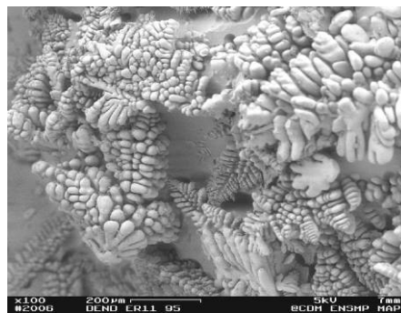
Figure I- 7 : Structures de zircon dendritiques dans un matériau THTZ [MADI-06].
