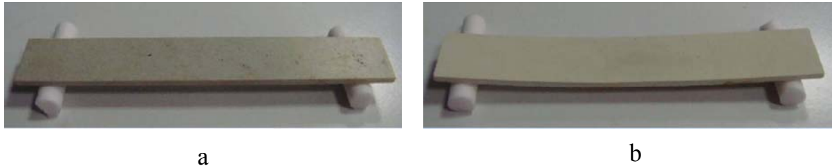
Figure V- 7 : Fléchissement après attaque HF d'échantillons de 3 mm d'épaisseur de THTZ-A (a) et de THTZ-B (b) [DING-10].
