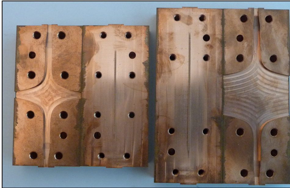
FIGURE III.1 – Dispositifs de mesure à 100 GHz : la ligne à 105 ailettes et la ligne à 155 ailettes avec les zones de transition incorporées dans la capot.
