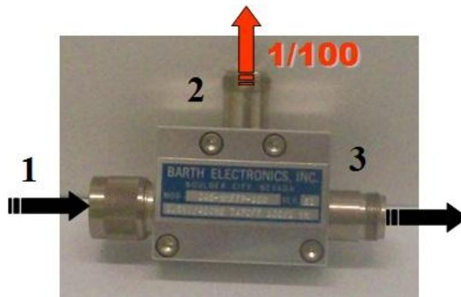
Figure II.18: Extracteur des signaux (245 NMFFP-100, Barth Electronics Technology, USA)
