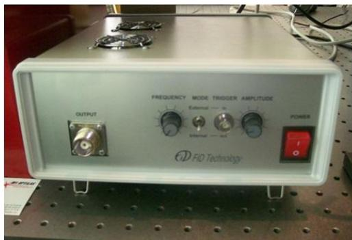
Figure II.11: Générateur FID (FPG 10-1SM10, FID Technology, Allemagne)
