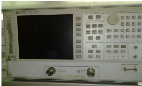
Figure II.22: Analyseur de réseaux vectoriel (Agilent technology)
