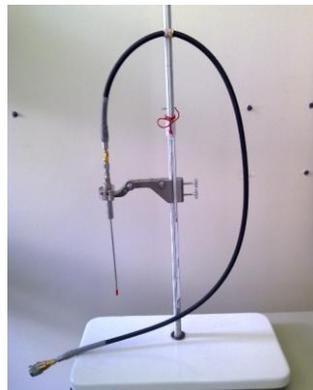
Figure II.23: Sonde diélectrique (85070E Dielectric probe kit, Agilent, USA)
