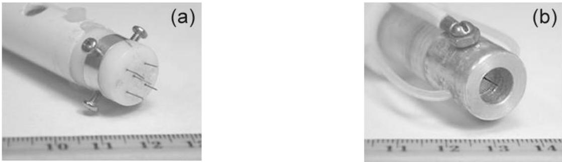
Figure I.19 (a) Applicateur à 5 électrodes à aiguilles (b) applicateur en anneau avec une électrode à aiguille.
