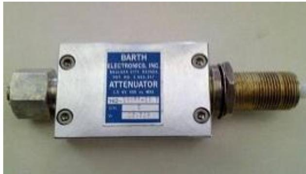
Figure II.25: Atténuateur Haute tension de connecteur GHV (GHMF, Barth Electronics, USA)
