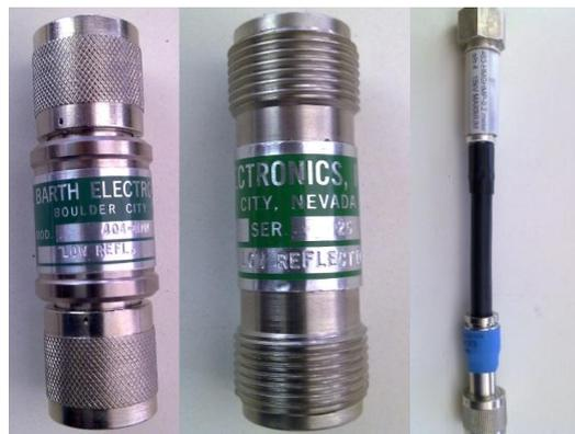
*Figure II.24: Connecteur haute tension et transition HNB (Barth Electronics Technology, USA)*
