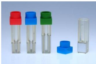
*Figure III.13: Cuvette biologique avec deux électrodes*
