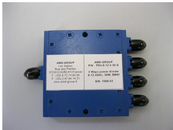
Figure IV-12. Diviseur de puissance AMD 8-12 GHz, 30W
