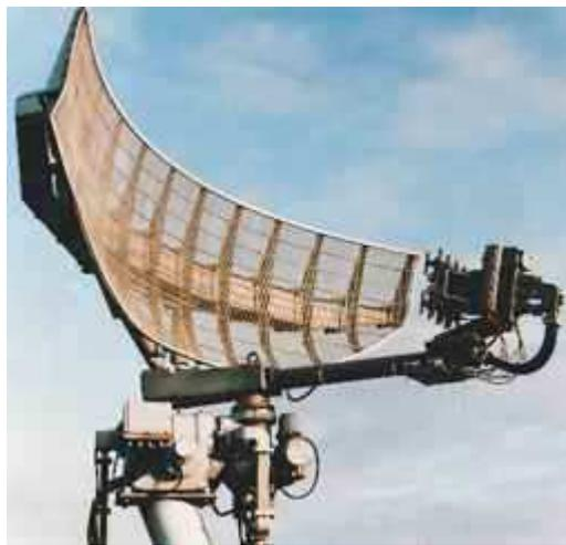
**Figure I-1. Antenne à balayage mécanique**
