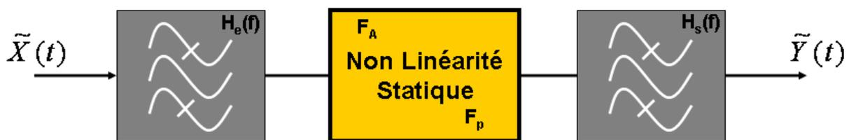
Figure III-2. Modèle d'Hammerstein-Weiner
