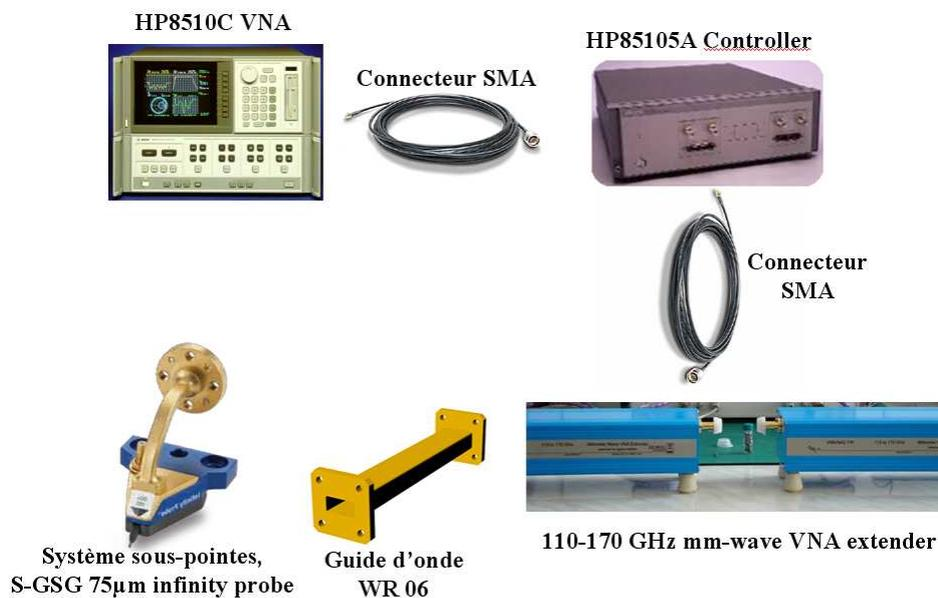
Figure IV-4 : Technique de mesures sous-pointes à 150 GHz
