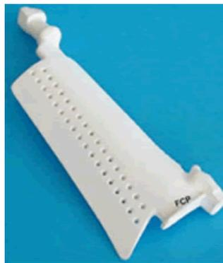
*Figure I-15 : Un « core » d'une turbine fabriqué en zircone par SLA 3D [I-3]*
