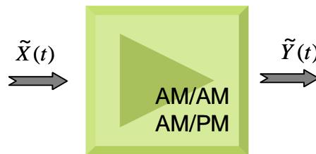
Figure II-4 Modèle amplificateur de puissance sans mémoire
