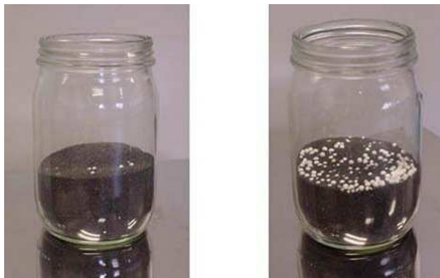
Figure 2.17 : Exemple de ségrégation dans le cas de poudres de densité différente (billes de céramiques blanches plus grosses et plus lourdes que les grains de sable noir) après vibration du mélange homogénéisé. [Projet ARC]
