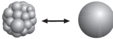
Figure 1.3 – La méthode adaptative la plus couramment utilisée est de fusionner plusieurs petites particules en une plus grosse et inversement de subdiviser une grosse particule en plusieurs petites (extrait de [DC99]).
