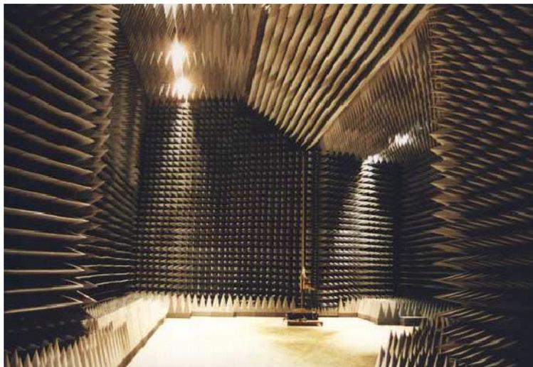
Figure I- 8 : Chambre semi – anéchoïque de grandes dimensions
