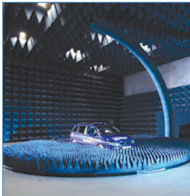
Figure I- 10 : Chambre anéchoïque de grandes dimensions à arche sphérique
