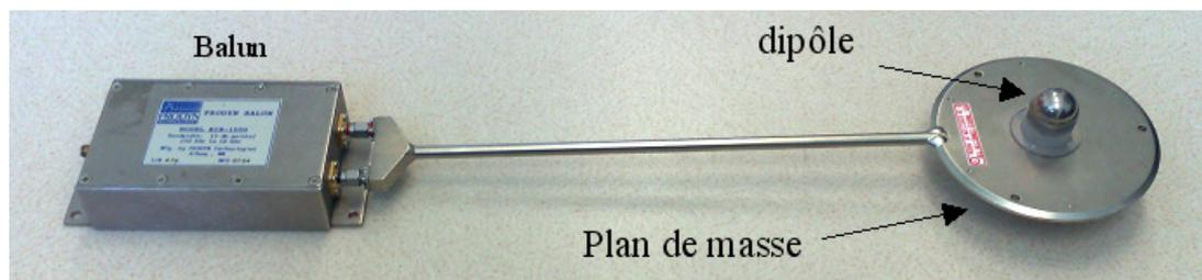
Figure IV-8 : Capteur de champ électrique type AD fabriqué par Prodyn
