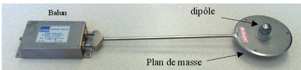
Figure A.VII- 1 : capteur de champ électrique AD-55
