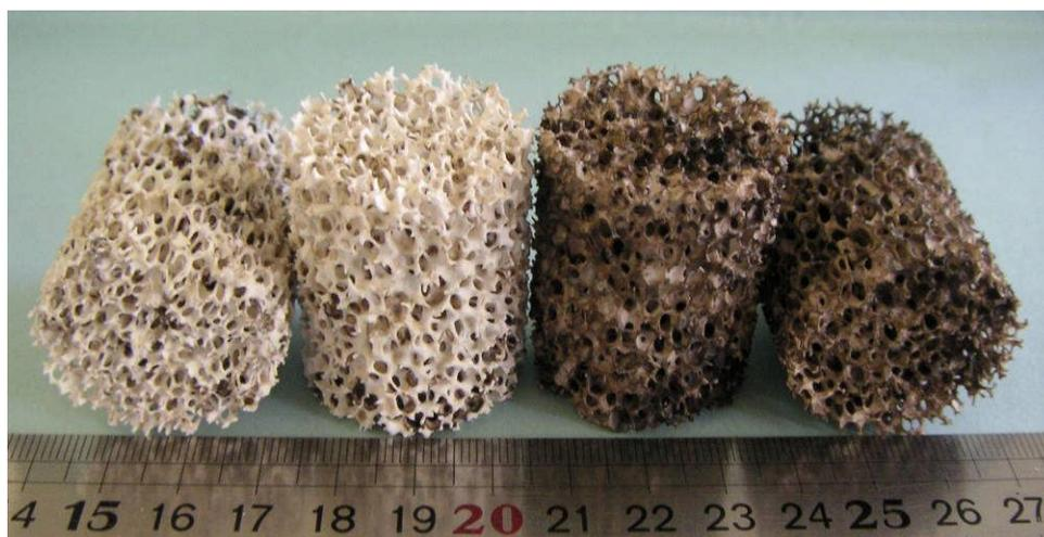
**Figure V.2-14: Catalyseurs supportés préparés par imprégnation d'un dépôt de spinelle (gauche) ou d'un dépôt de spinelle lavée et chargée en PSS (droite) par une solution de nitrates de rhodium diluée.**
