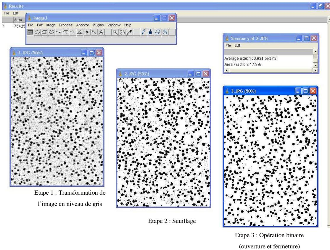
Figure A3-1 : Traitement d'une image sous Image J.
