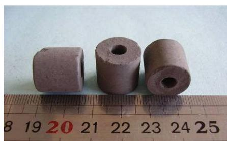
Figure I.6-3 : Un catalyseur type pour le vaporeformage du gaz naturel, le catalyseur Süd Chemie G90B.
