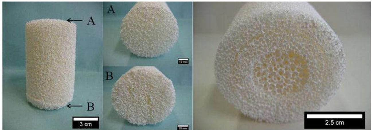
**Figure IV.3-2 : Mousses d'alumines produites par imprégnation de supports PU présentant des gradients de porosité.**
