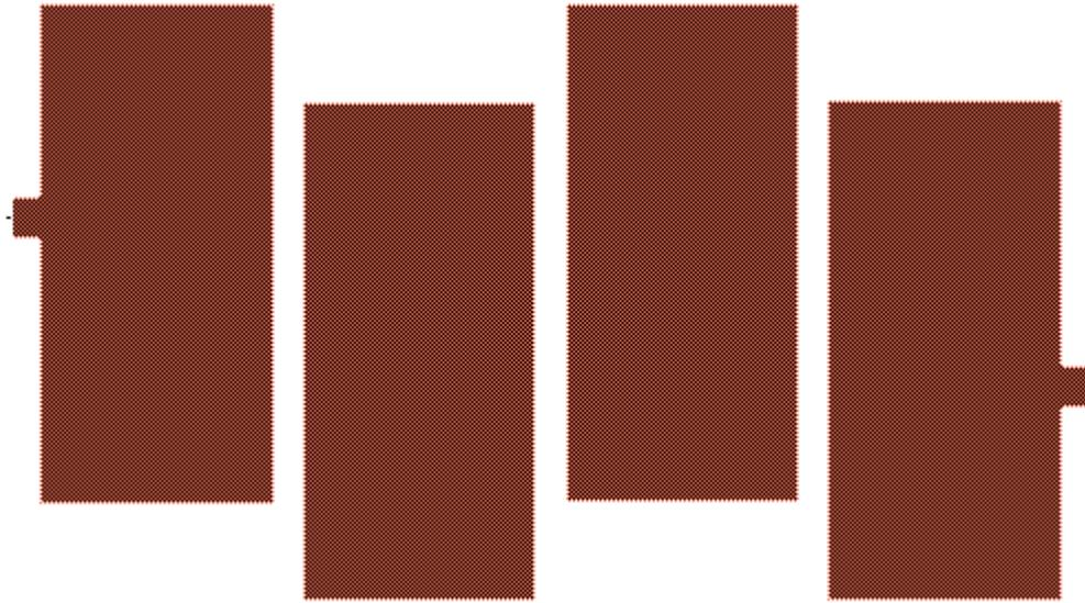
**figure 57.** filtre 4 pôles avec des résonateurs demi-onde
