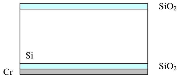
**Figure A.1 : Dépôt des couches de masque**
