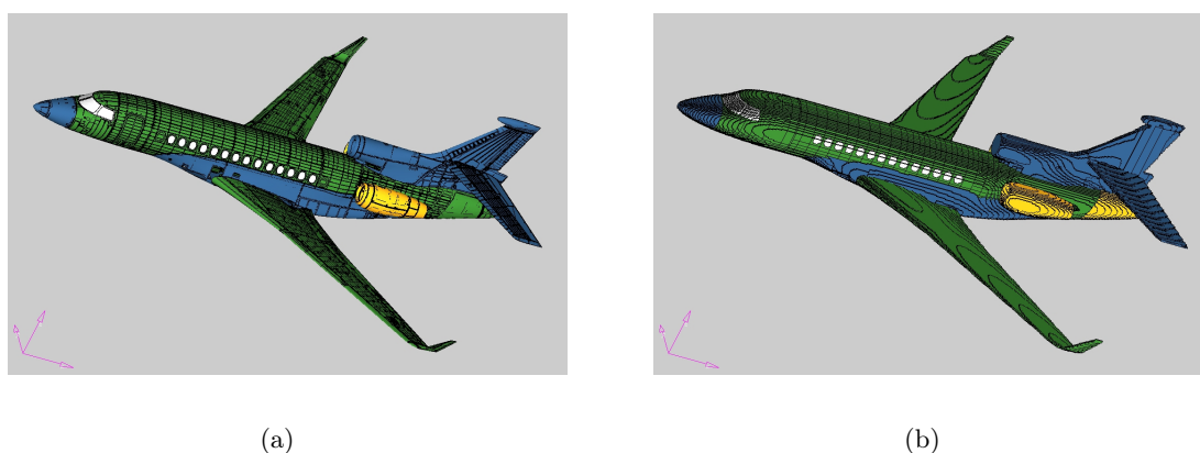
FIGURE 4.5 – Géométrie simplifiée de la peau externe (a) et maillage (b)
