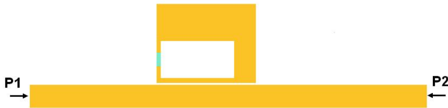
Figure IV.10 : Design du résonateur sous ADS Momentum.
