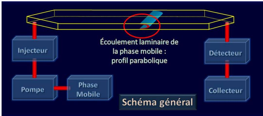
FIGURE A.1 – Schéma général d'un canal de séparation de FFF.
