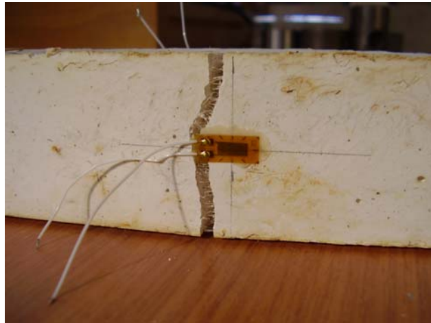
Figure 14: Jauge de déformation collée sur la face d'une éprouvette soumise en tension lors d'un essai de flexion 4 points
