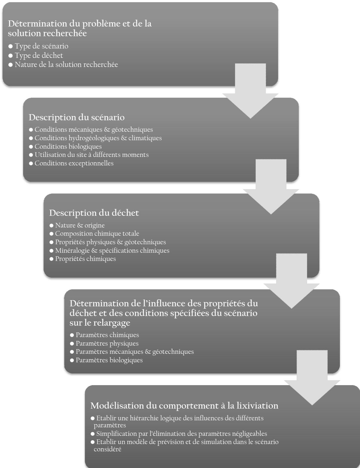
Figure III-1. Principe de la méthodologie à appliquer lors de la détermination du comportement à la lixiviation d'un déchet, selon la norme EN 12920.
