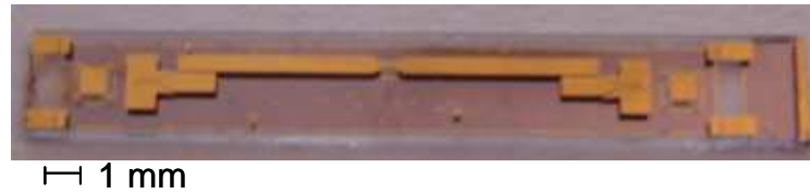
Figure III-11 : Photographie d'une puce comprenant un filtre après découpe.
