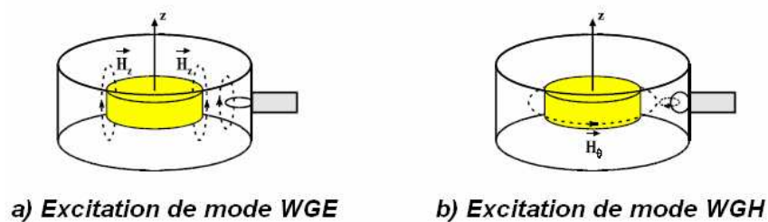
Figure III-9 : Couplage par sonde magnétique de modes de galerie
