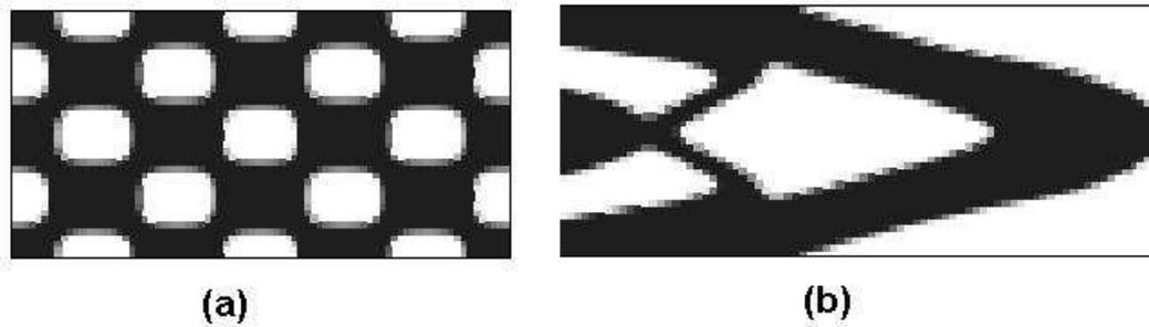
Figure I.7 Cantilever optimisé par la méthode des courbes de niveaux : condition initiale (a), forme optimale (b).
