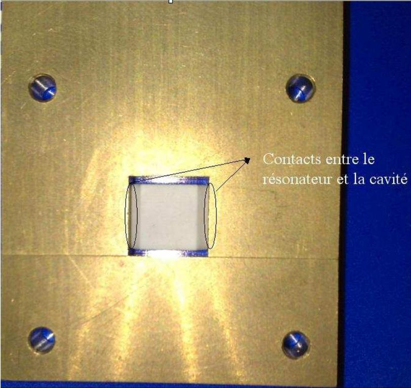
Figure III.23 Résonateur diélectrique inséré dans une cavité métallique.
