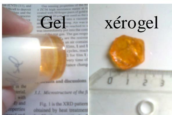
Figure 2 : gels et xérogels de SnO<sub>2</sub> obtenus à partir d'un sol de SnCl<sub>2</sub>,2H<sub>2</sub>O modifié dans l'éthanol pur (C = 0,5M)
