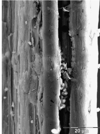
Figure 2.13 Surface d'une fibre non traitée observée par MEB
