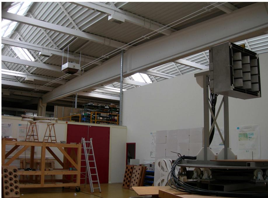
Figure IV - 2 : réseau d'antenne et antenne de réception (Valentine)
