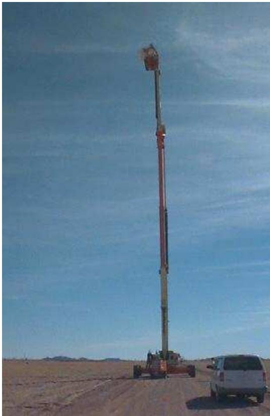
La figure I-9 montre le système BoomSAR, le Radar est à une hauteur de 45m et le véhicule peut se déplacer à une vitesse de 1 km/h. La portée de ce système est de 60m.
