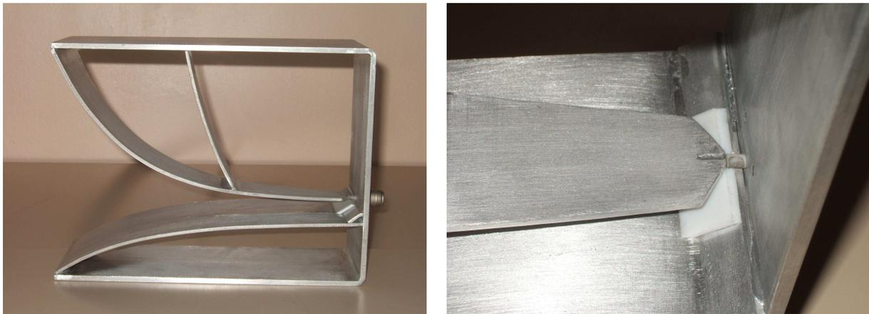
Figure II - 37 : prototype de l'antenne élémentaire
