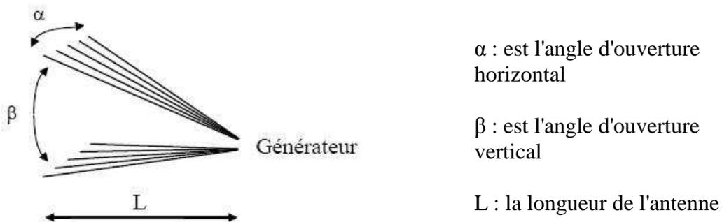
Figure I- 27 : antenne filaire multi - brins
