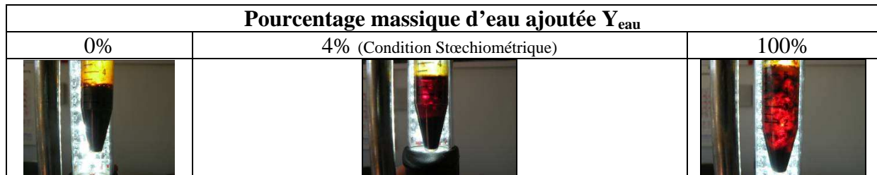
Figure 60 : Observation du phénomène de démixtion de l'huile de pyrolyse utilisée dans cette étude lors de l'ajout d'eau
