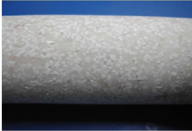
Figure II-4. Matériau modèle verre-alumine
