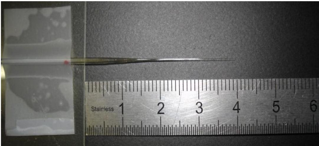
Figure IV-19: Canne microstructurée effilée
