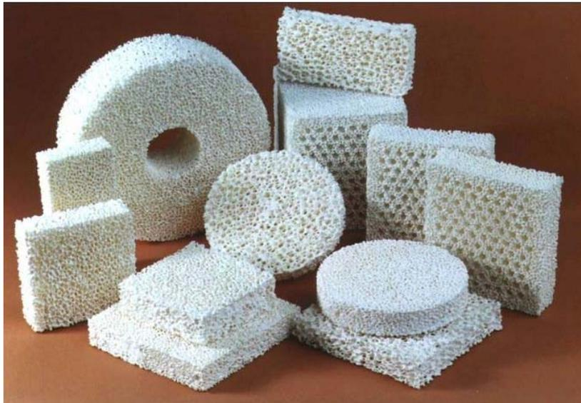
*Figure I.5. : Corps poreux élaborés à partir de composites mullite/alumine/et zirconie.*
