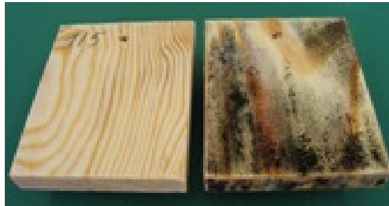
FIG. 2.13: Comparaison entre une planche de bois saine et une planche recouverte de diverses moisissures.
