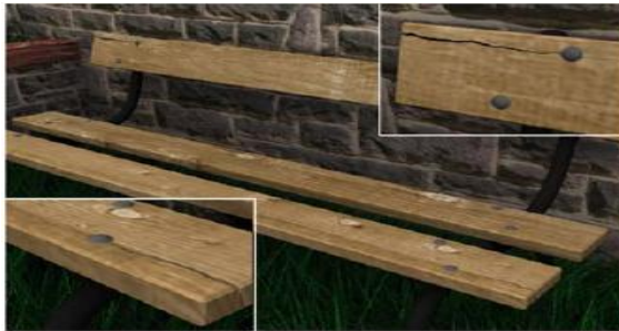
FIG. 2.4: Un banc en bois présentant des fissures [DGA05].
