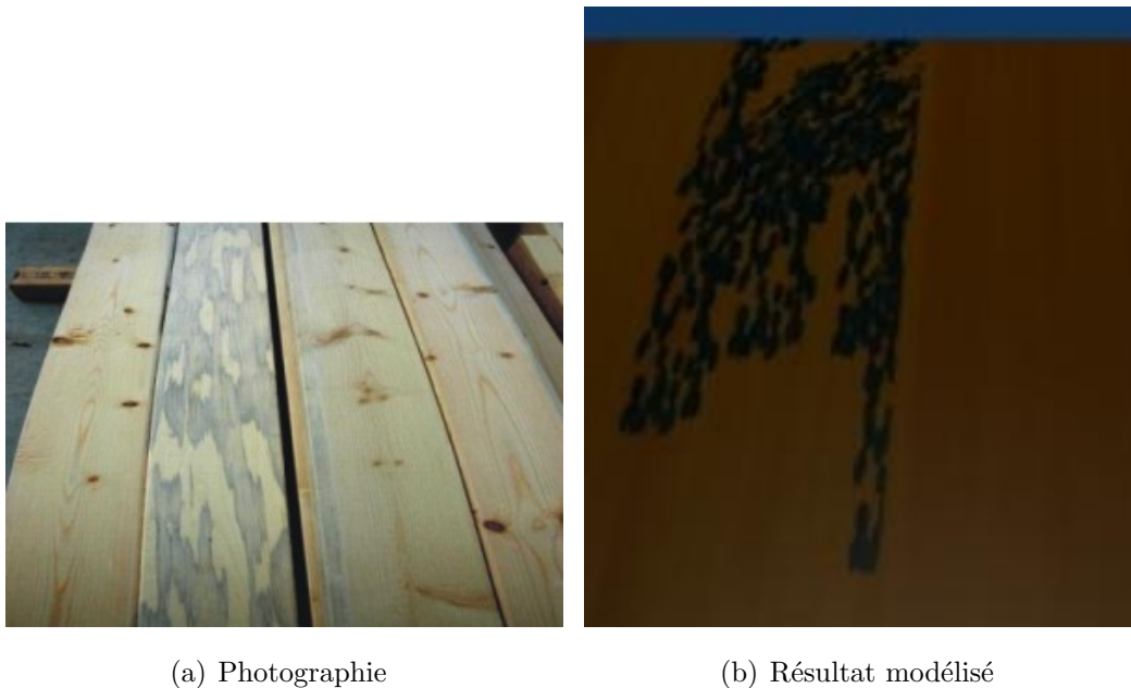
FIG. 2.16: Le résultat d'une attaque de champignons (blue stain fungi) sur une planche de bois. (a) Une photographie du phénomène ; (b) Le résultat obtenu avec notre méthode.
