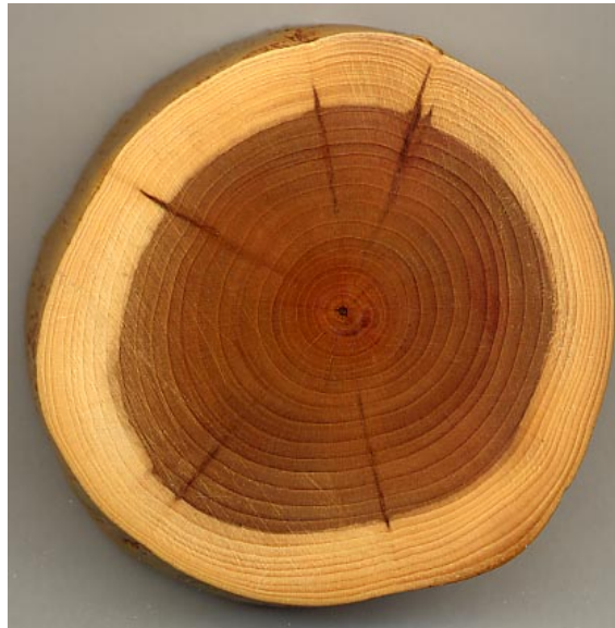
FIG. 1.2: Une image issue du monde réel, montrant une coupe transversale d'un morceau de bois. La partie centrale plus foncée correspond au duramen , alors que la partie périphérique correspond à l' aubier .
