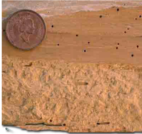
FIG. 2.5: Photographie issue du monde réel, représentant un morceau de bois attaqué par des insectes.
