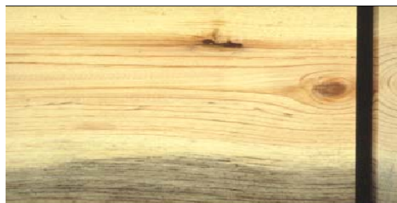
FIG. 2.12: Aspect d'un morceau de bois attaqué par des champignons de bleuissement.
