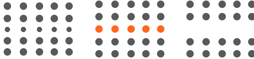
FIG.A.2 – Différents types de défauts basés sur la rupture de la périodicité du motif élémentaire.
