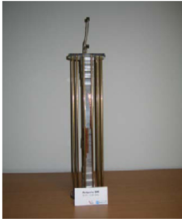
Figure I.31. Antenne BIE-M coaxiale omnidirectionnelle et ses diagrammes de rayonnement
