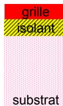
figure 1- 14 : Structure de la capacité MOS
