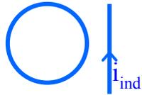
figure 3- 5 : Interaction maximale, fort courant induit
