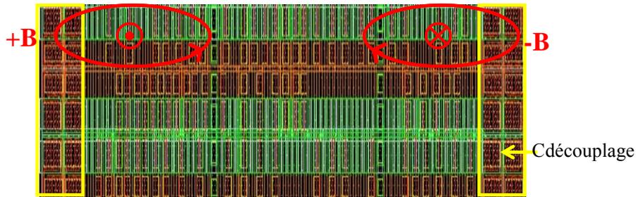
**figure 2- 33 : Boucles de courant de flux opposé fermées par des capacités de découplage disposées symétriquement de chaque côté du bloc**
