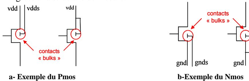
figure 2- 30 : Caisson des transistors polarisés séparément ou non
