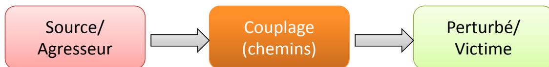
**figure 1- 4 : Synoptique de l'effet monodirectionnel du couplage entre deux entités**
