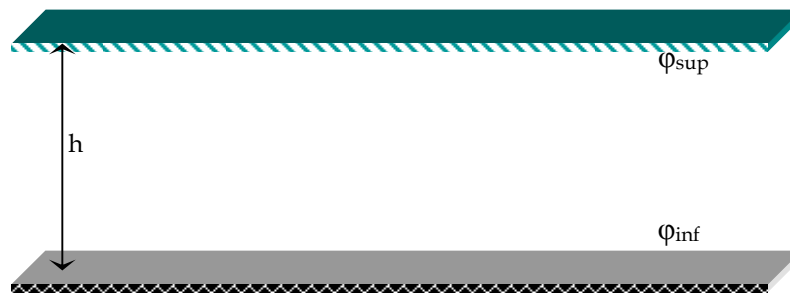
Figure IV-1- Conception généralisée de l'antenne à résonateur BIE, \varphi_{\text{inf}} est la phase du coefficient de réflexion du plan de masse, \varphi_{\text{sup}} est la phase de l'interface supérieure, h est la hauteur résonante.
