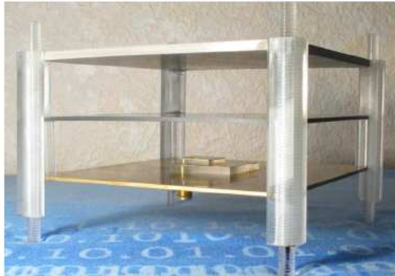
Figure III-14- Antenne à résonateur BIE diélectrique bi-bande à double défaut. Diagrammes de rayonnement dans les deux bandes de fonctionnement à 4.2 GHz et 7.4 GHz [52].
