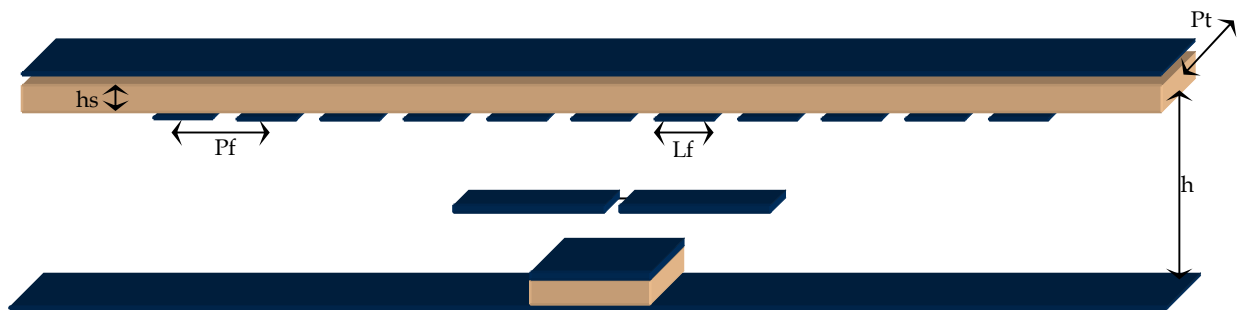
Figure III-41- Géométrie de l'antenne BIE à interface supérieure structurée excitée par un patch imprimé ou un dipôle.
