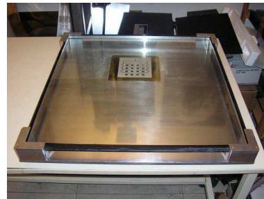
(b) Antenne B.I.E. pour dépointage alimentée par un réseau de patch
