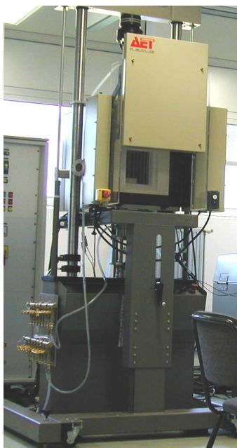
Figure 6 : Machine d'essai flexion 4 points à haute température utilisée au CROMeP
